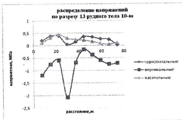
Рис.4. Распределение горизонтальных, вертикальных и касательных напряжений по разрезу 13.
