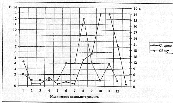
Рис. 2. ЭМП в аудитории 259 ГМК (электрическая составляющая в диапазоне частот 5-2000 Гц)
