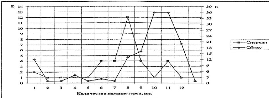
Рис. 2. ЭМП в аудитории 259 ГМК (электрическая составляющая в диапазоне частот 5-2000 Гц).
