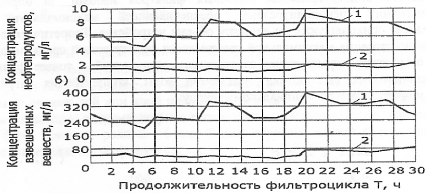
Рис. 8. Кинетика очистки поверхностных сточных вод фильтрованием через листовую открытоячеистый пенополиуретан при V=1\text{м/ч} .
