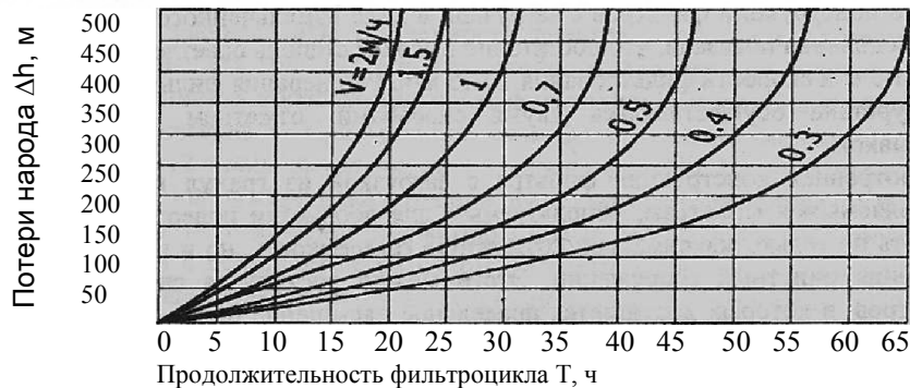
Рис. 9. Изменение потери напора в загрузке фильтра.
