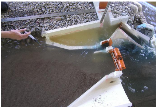
Рисунок 2 – Осенний режим работы водозаборного сооружения на модели деривационной ГЭС на р. Иссык-Ата
