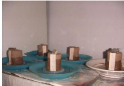
Рис 2. Капиллярное поднятие воды при различных диаметрах платформы.
